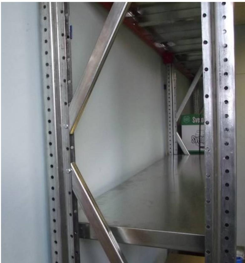
Стеллаж представляет собой металлическую конструкцию, имеющую секционную структуру. Стеллаж является сборно-разборным изделием. Он состоит из следующих элементов:
