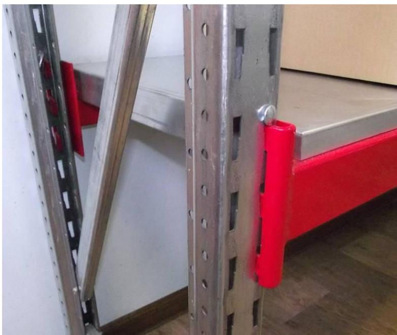
балок – быстросборный, безболтовой. Балки, выполненные в виде прямоугольных прокатных труб, имеющих с обеих сторон кронштейны с зацепами, которые присоединяются в конусообразную перфорацию стоек рам. На зацепах имеются специальные выпуклости (пуклевка), которые входят в конусную часть перфорации, тем самым обеспечивая крепкое сцепление со стойкой рамы. Для предотвращения случайного разъединения балки со стойкой, обязательно устанавливается фиксатор.
